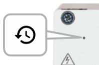
Si se cambian la dirección del dispositivo y/o la velocidad en baudios, el botón se puede utilizar para restaurar los valores predeterminados. Para ello, presione y mantenga presionado el botón y encienda la alimentación. Cuando el diodo rojo se encienda, suelte el botón. Cuando el diodo verde se encienda, significa que los parámetros se han restablecido a los valores predeterminados.
